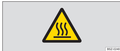
Abb. 7 Warnschild für heiße Oberflächen auf dem Ladegerät.
