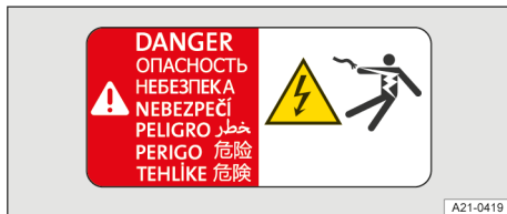
Abb. 4 Warnschild auf Hochvoltkomponenten.
