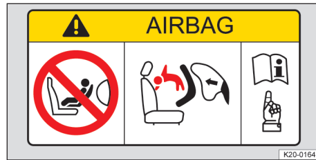
Abb. 1 Airbag-Aufkleber an der Sonnenblende (Prinzipdarstellung).
