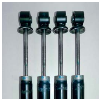
Volkswagen Original Stoßdämpfer nach 1.000.000 Lastwechseln
